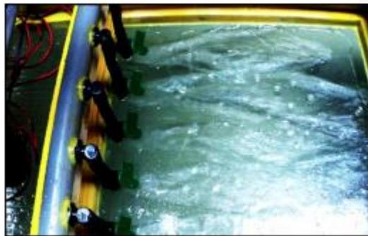
*Ilustración 1. Distribución de la capa de aire en el fondo de la barcaza.*
